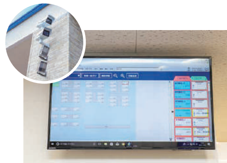
▲車両ナンバー情報をカメラで検知し即座に通知
